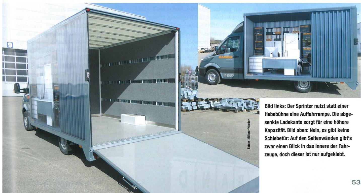
**Bild links:** Der Sprinter nutzt statt einer Hebebühne eine Auffahrrampe. Die abgesenkte Ladekante sorgt für eine höhere Kapazität. **Bild oben:** Nein, es gibt keine Schiebetür: Auf den Seitenwänden gibt's zwar einen Blick in das Innere der Fahrzeuge, doch dieser ist nur aufgeklebt.
